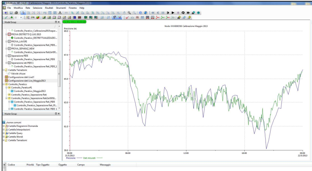
Figura 11.2: Confronto fra dato misurati e risultati del modello ai fini della calibrazione
